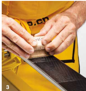
Abb. 3) Den Belag nun gut polieren. Diese Arbeit wird mit der weissen Seite des Thermo Cork ausgeführt.
