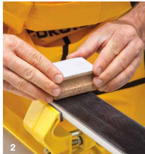
Abb. 2) Mit der Korkseite des Thermo Cork die JetStream Schicht gut in den Belag einpolieren.
